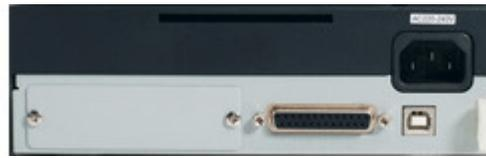
Mit integrierter USB- und serieller Schnittstelle ist der CL-S400DT eine zukunftssichere Investition. Ethernet- und parallele Schnittstellen stehen optional zur Verfügung.
