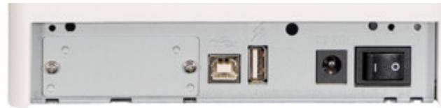
Standard-USB-Schnittstelle mit optionalem Schnittstellenkartensteckplatz für Bluetooth, Ethernet, Wireless LAN oder USB-Hosts + LAN
