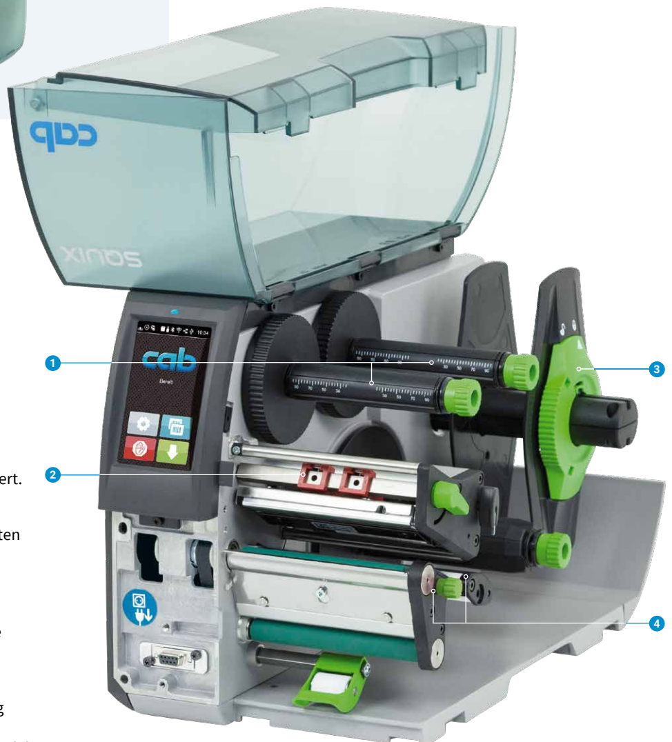
Etikettendrucker SQUIX 4 MP, Spendegerät mit internem Aufwickler
